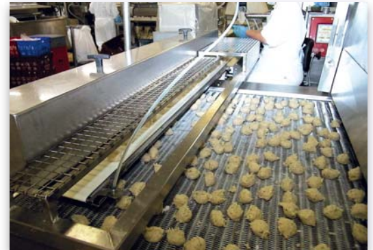
Dépose de produits en amont d'un tunnel cryogénique
