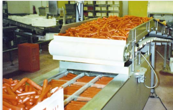
Equipement de postes de travail pour remplissage de barquettes
