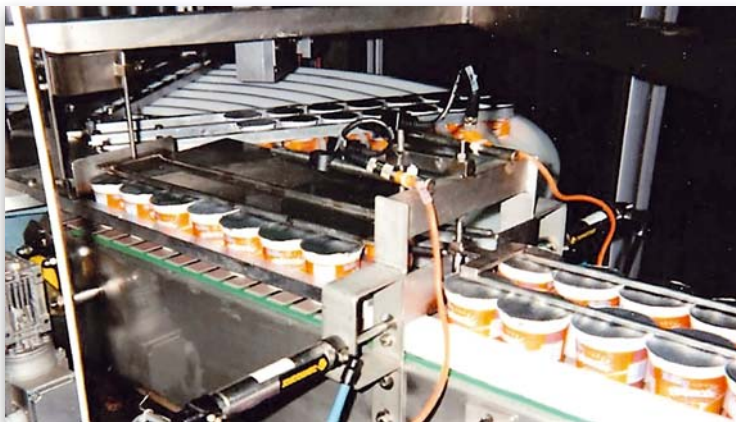
Encliquetage de coupelles de céréales sur yaourts
