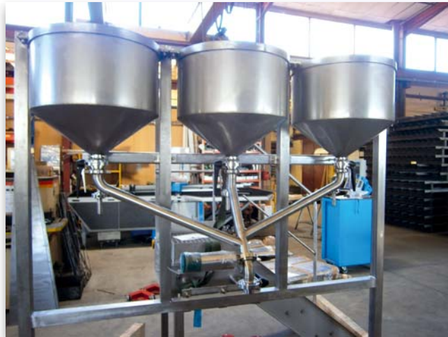
Installation de dosage de sauces (INOX 316 L)
