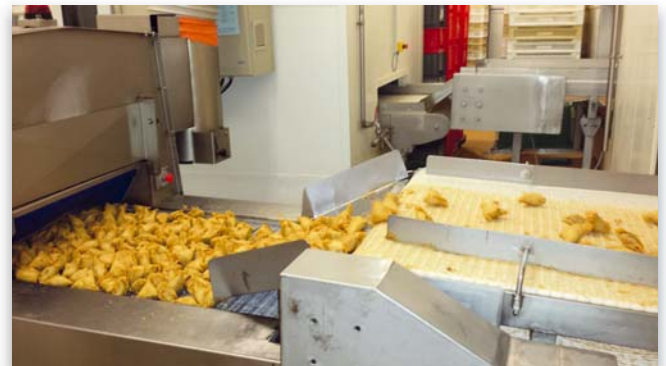
Transfert de produits entre friteuse et surgélateur
