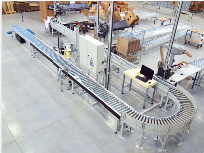
Chaîne de mise en cartons, pesage, étiquetage avec code-barres
