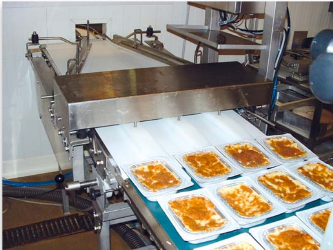
Séparateur 4 en 1 pour pesage et étiquetage unitaire
