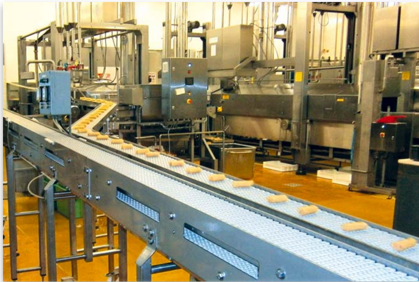
Liaison entre ligne de production et friteuse
