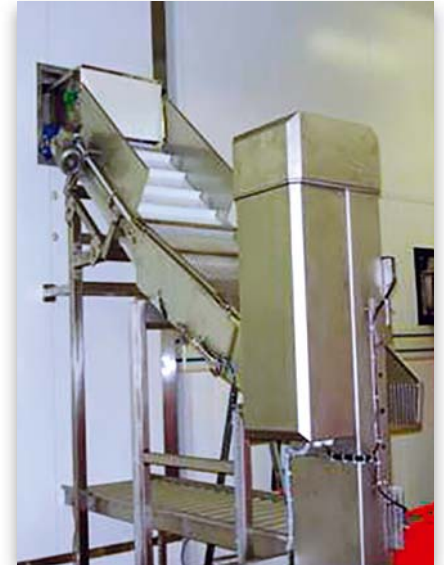
Mise en bacs de produits nus surgelés pour stockage en chambre froide
