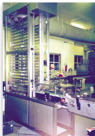
Stockage tampon sur ligne automatisée
