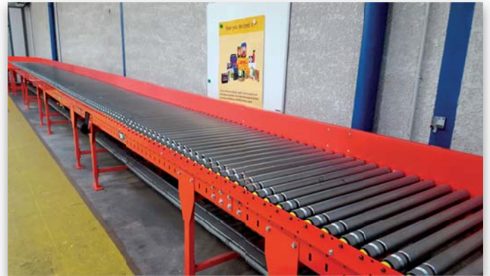
Ligne mécanisée de tri manuel
