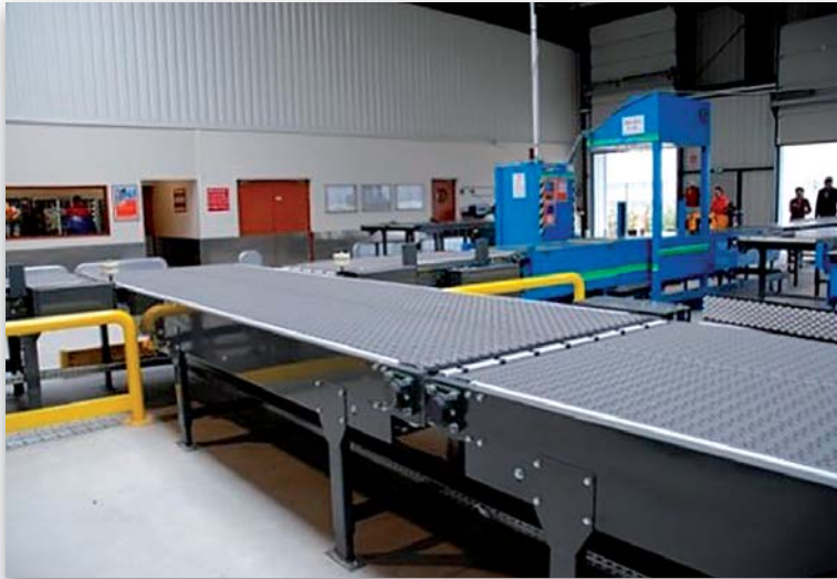
Convoyeur de dispatch à bande modulaire pour tri assisté
